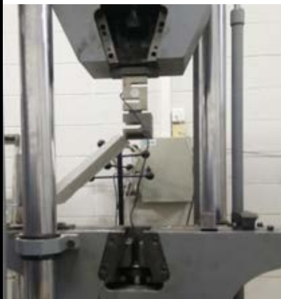
Servosis ME 402E per assaig de fatiga
